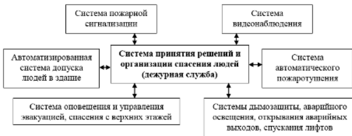
Рисунок 2 – Вариант построения комплексной системы безопасности в здании
